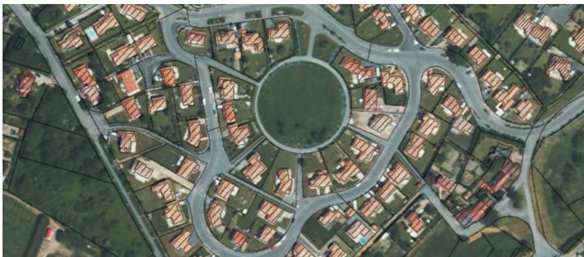
Lotissement du Petit Anjou: la voie principale permet de desservir l'ensemble des lots Les espaces publics sont réduits à une chaussée et 2 trottoirs Les espaces verts se concentrent au milieu du lotissement, sorte de jardin réservé aux résidents, complètement protégé de la circulation
